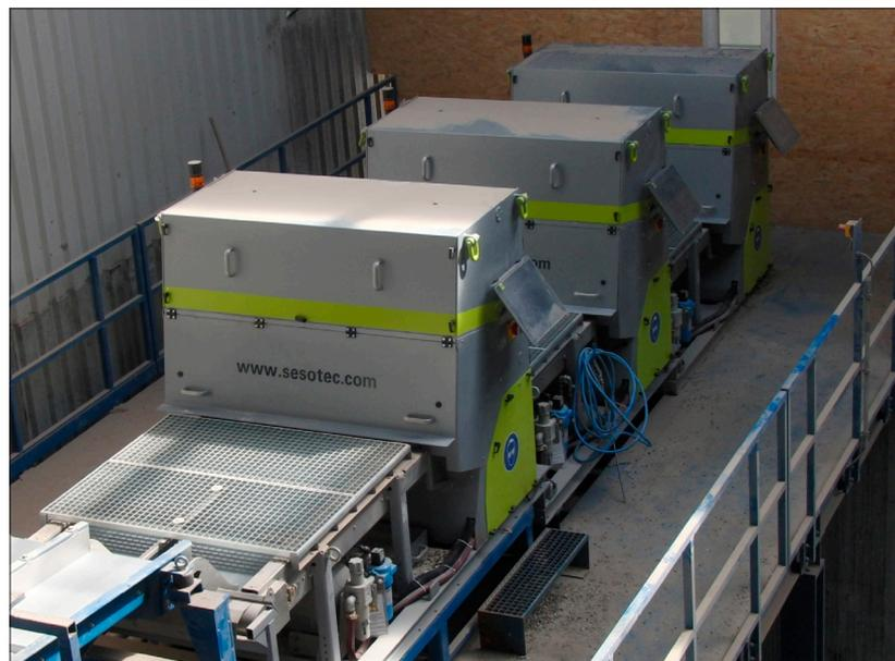
Die Feinlinie in der Reiling Glasrückgewinnungsanlage mit drei K9-Geräten von Sesotec.
