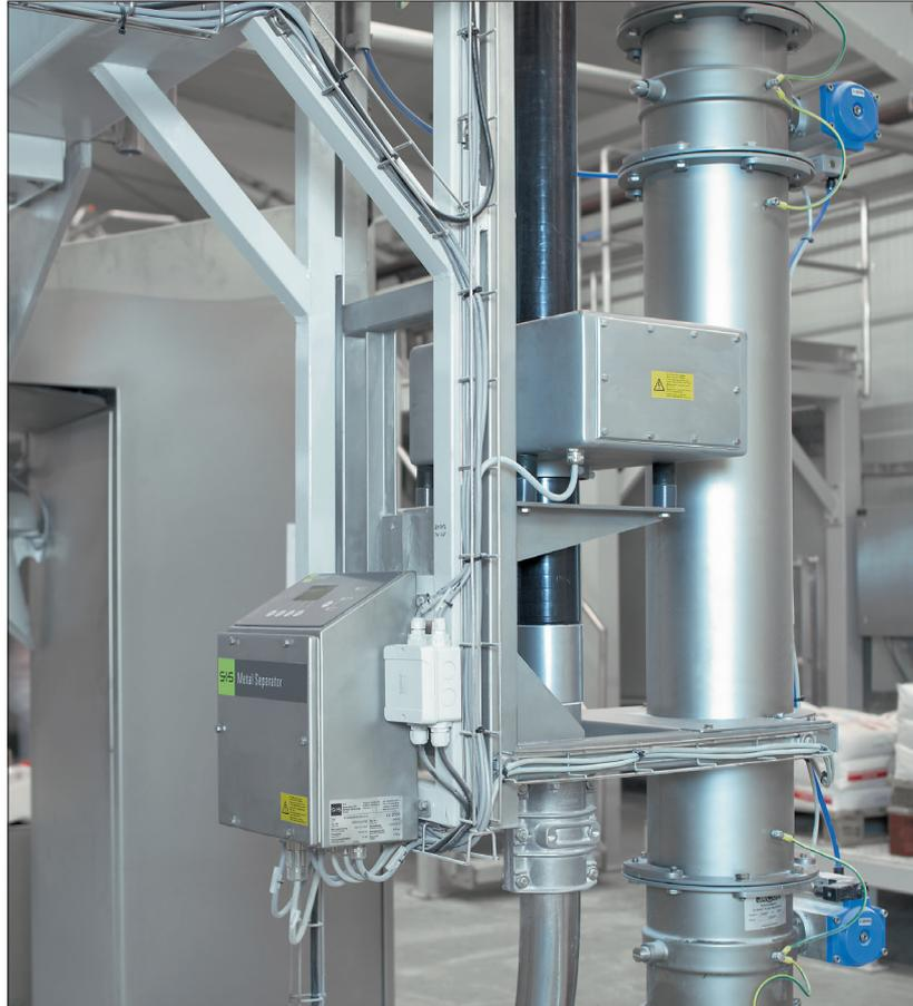
Der Sesotec Metall-Separator GF 4000 ist in eine pneumatische Förderleitung integriert.
