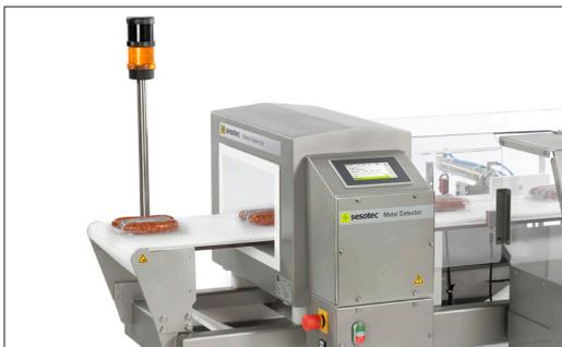
VARICON+W mit GLS und mit Gliedergurt zur Untersuchung von verpackten Stückgütern im Nassbereich.
