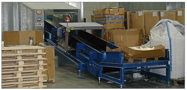
Einbaubeispiel: Tunnel-Metall-Detektor DLS bei der Untersuchung von Recyclingmaterial vor der Mühle (alte Ausführung)
