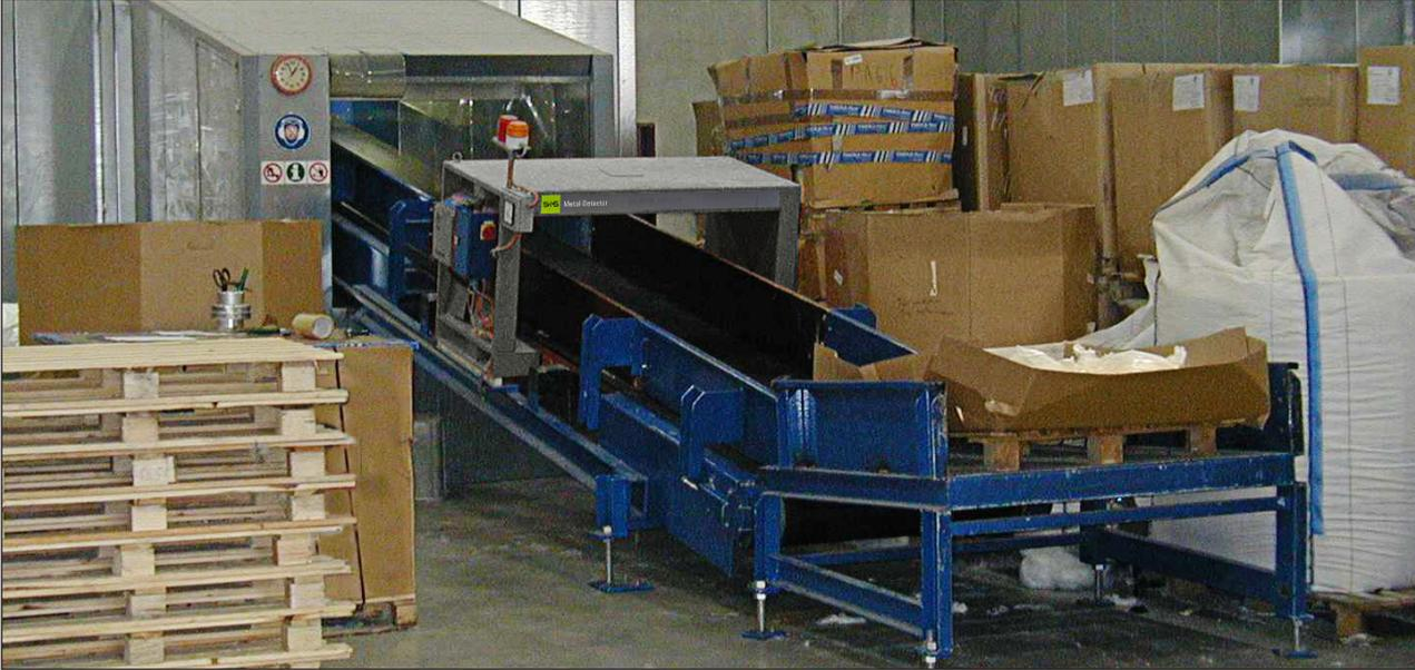
Einbaubeispiel: Tunnel-Metall-Detektor DLS bei der Untersuchung von Recyclingmaterial vor der Mühle (alte Ausführung)
