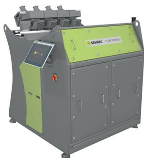
Das Multi-Sensorsortiersystem FLAKE PURIFIER+ wurde eigens für den Einsatz in der Kunststoffrecycling-Industrie konzipiert. Die Materialzuführung erfolgt über eine speziell angepasste Vibrationsförderrinne. Neben den Sensoren zur Metall- und Farbseparation hat Sesotec auch hier ein Hochleistungsmodul zur Erkennung von Fremdstoffen, wozu auch unterschiedliche Kunststoffarten gehören, im Einsatz.
