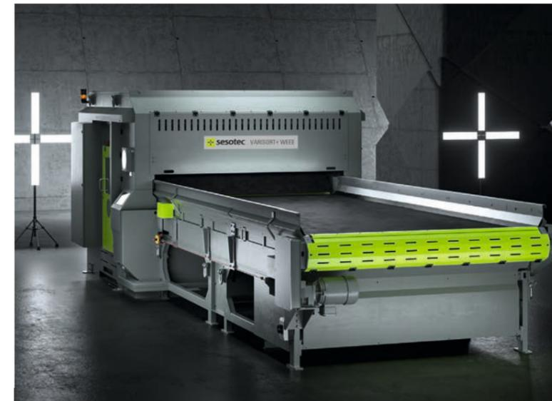
Sortiersystem für das Metall- & Elektroschrott-Recycling
