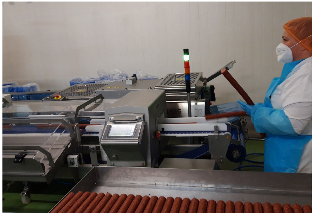
Um in unverpackten Salamistangen Aluclips-Teile zu detektieren, setzt die H. Loidl Wurstproduktions- und Vertriebsges. m.b.H & Co KG INTUITY Metaldetektoren mit THiNK-Software von Sesotec ein.
