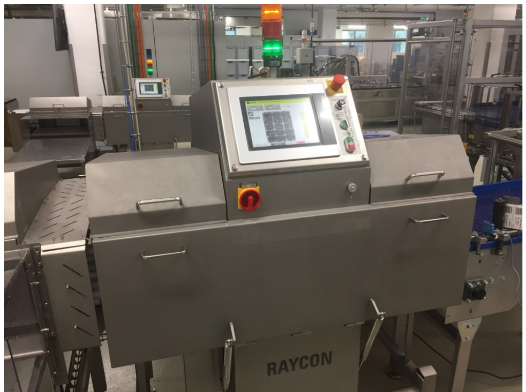
MANNER setzt für die Endkontrolle von verpackten Waffelschnitten RAYCON Röntgeninspektionssysteme von Sesotec ein.
