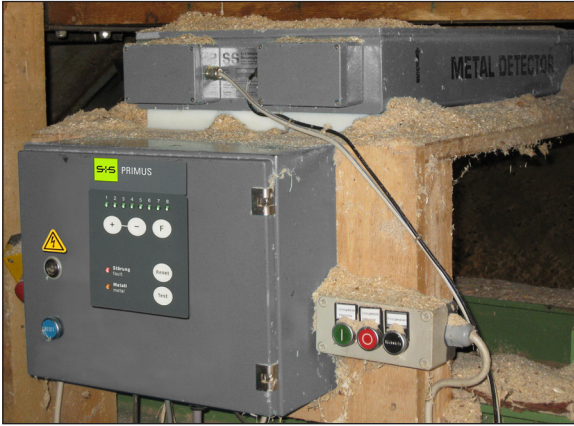
Einbaubeispiel: Flächen-Metall-Detektor ELS mit Control Unit PRIMUS bei der Untersuchung von Restholz (alte Ausführung)
